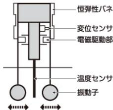
SV型（音叉型振動式）粘度計の測定理論・機構図
